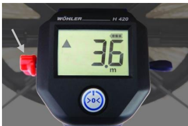
Rys. 10: Dźwignia do ustawiania hamulca
